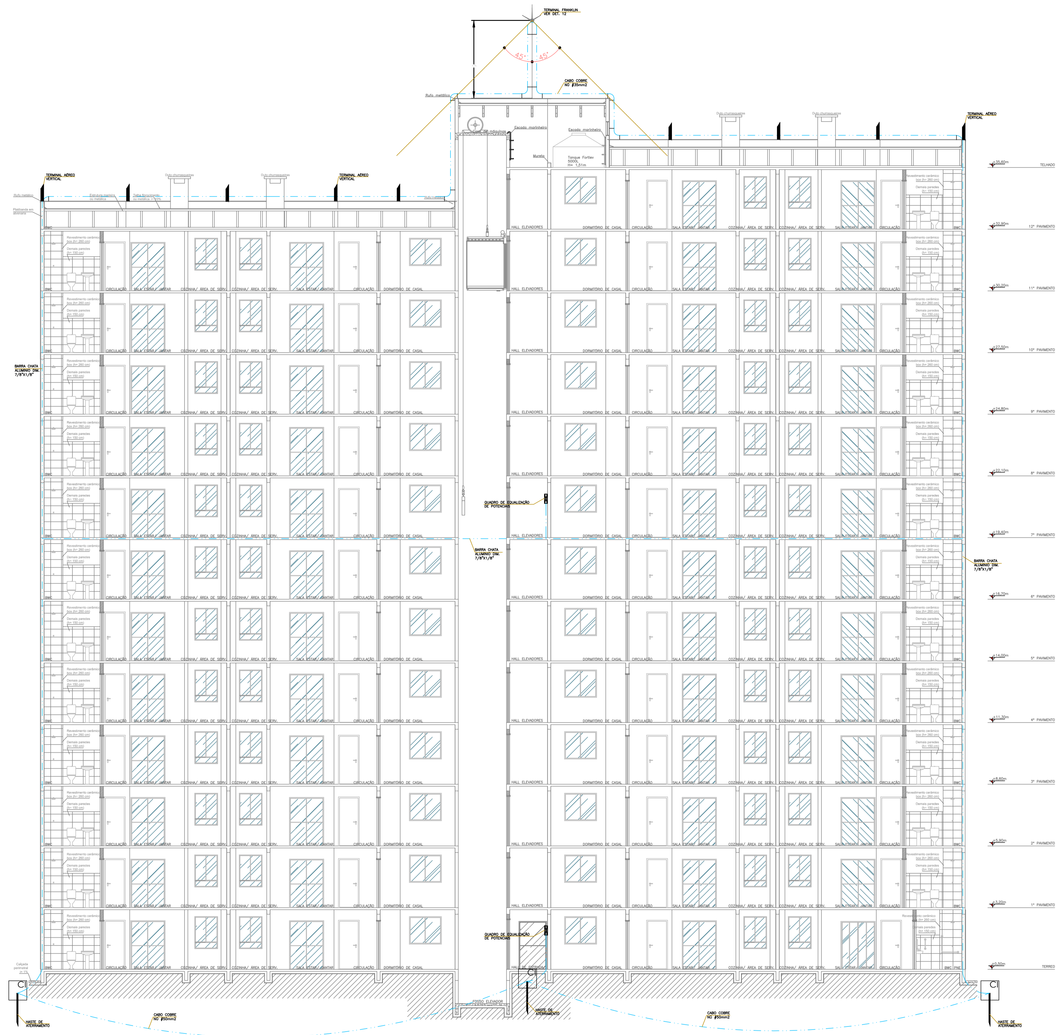
Corte esquemático instalação SPDA escala 1/100
