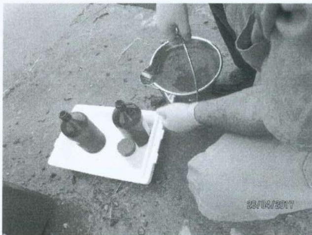
Figura 8 - Amostragem Saída EJ14 - ETE Jarivatuba
