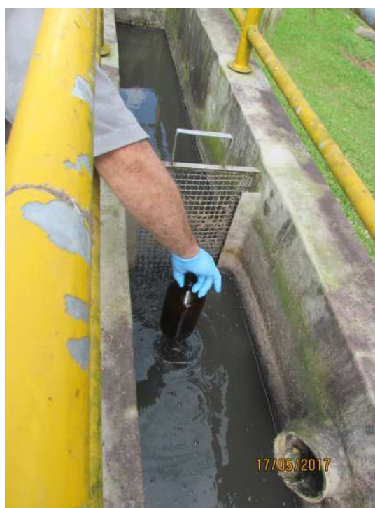
Figura 2 - Coleta no Ponto 02 – Entrada da ETE Profipo
