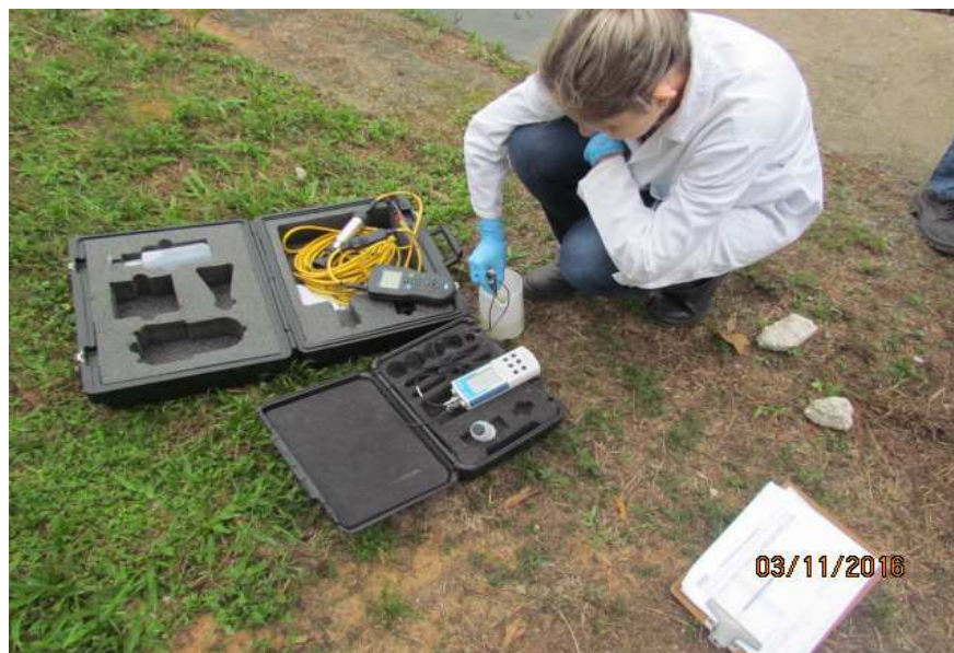
Figura 6 - Medição in loco da Saída EJ07 da ETE Jarivatuba
