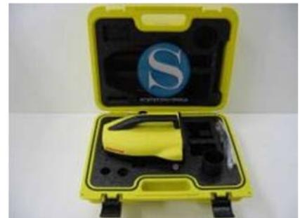
Figura 5.3 - Ilustração de um nível digital.
