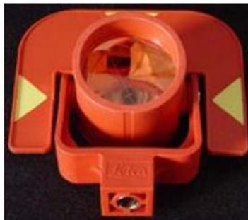
Figura 5.2 - Ilustração de um prisma refletor.
