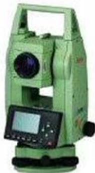
Figura 5.1 - Ilustração de uma estação total.
