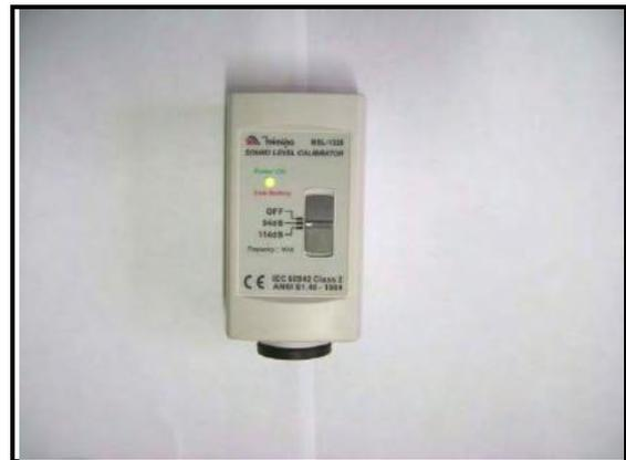
Figura 32 - Calibrador para o medidor de pressão sonora.
