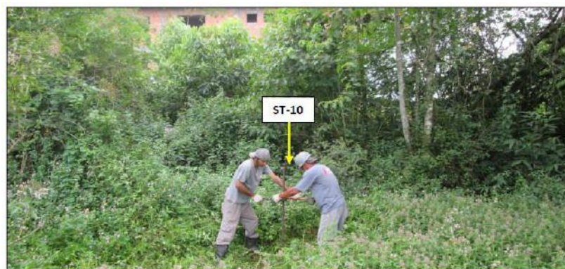
Figura 24: Sondagem executada com trado manual (ST-10). FONTE: Acervo Andes.
