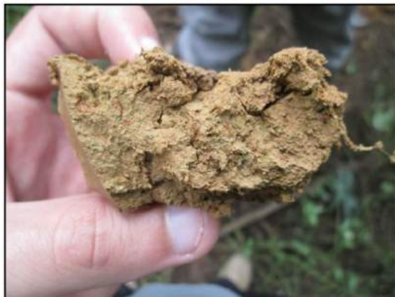
Figura 29: Material sondado de 0 a 0,55 m na ST-09 de composição argilo-siltosa. (FONTE: Acervo Andes)
