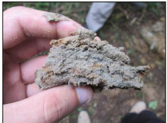
Figura 30: Material sondado de 0,55 a 0,90 m na ST-09 de composição argilo-arenosa. (FONTE: Acervo Andes)
