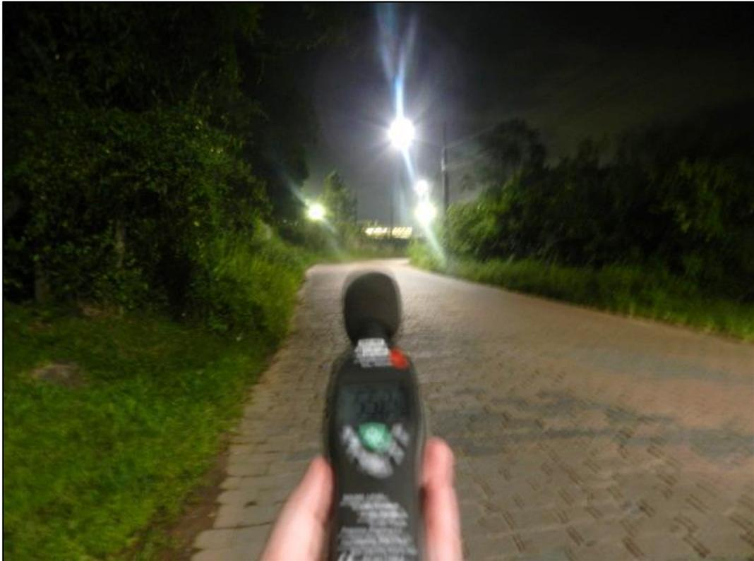
Figura 60: Medição de ruído no ponto amostral 5.
