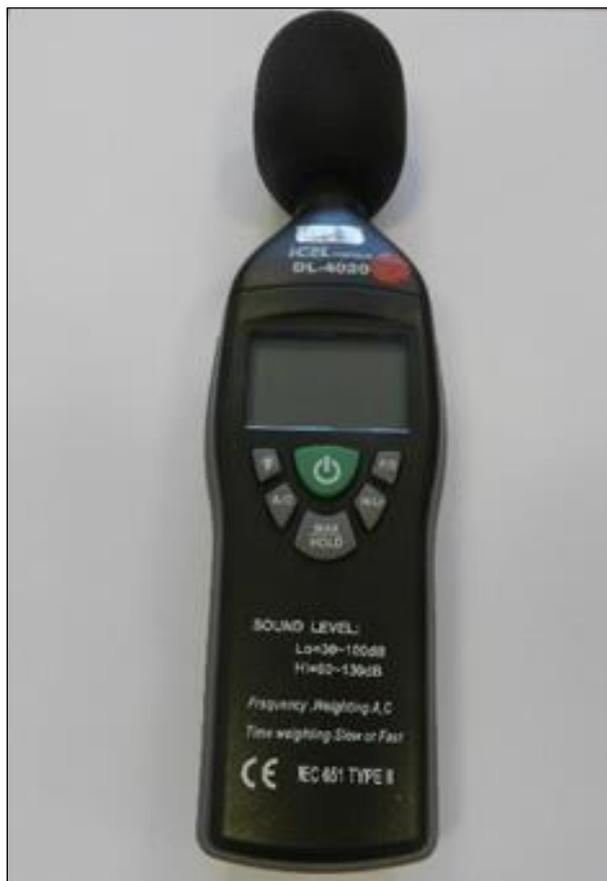
Figura 54: Medidor de pressão sonora utilizado durante as aferições.
