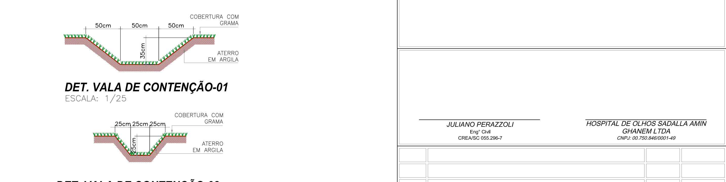
DET. VALA DE CONTENÇÃO-02 ESCALA: 1/25
