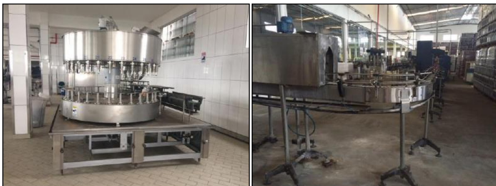
Figura 6. À esquerda, envasadora em processo de montagem para bebidas alcoólicas. À direita, final da linha de produção dos gaseificados.
