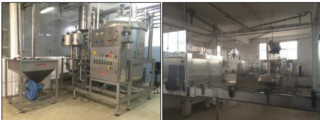
Figura 5. À esquerda, máquina diluidora e injetora de gás carbônico da linha de produção de gaseificados e energéticos. À direita, envasadora e linha de etiquetagem dos produtos.
