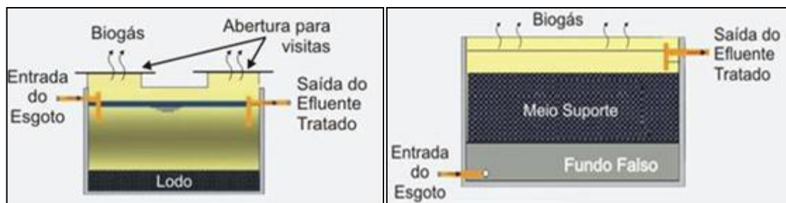
Figura 58: Ilustração do sistema de tratamento de efluentes (Tanque séptico e filtro anaeróbio).
