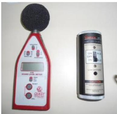
**Figura 01:** Decibelímetro e calibrador de nível sonoro utilizados
