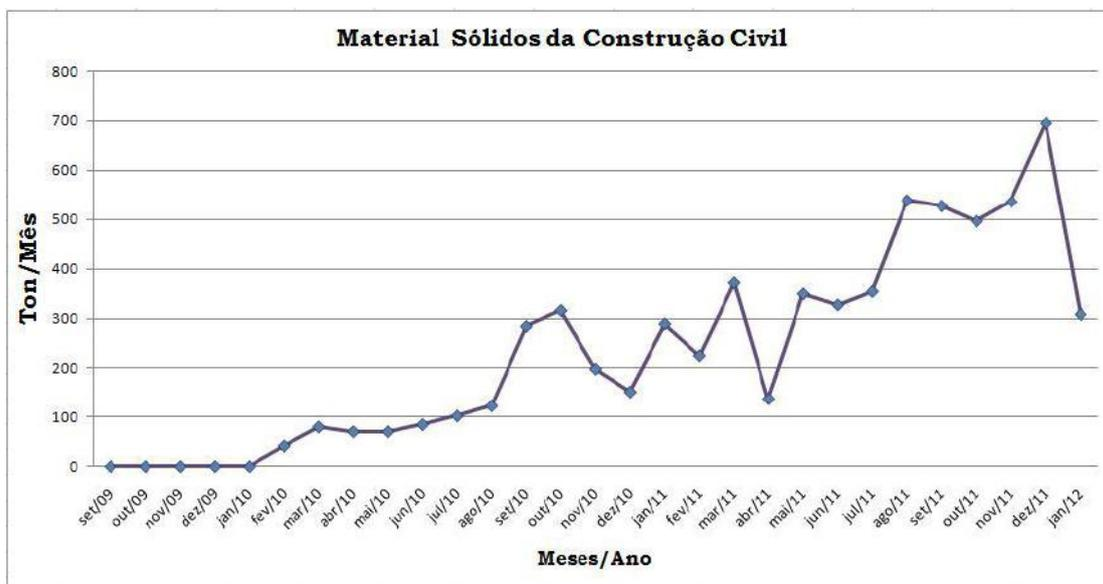
**Figura 129** - Quantitativo de resíduos da construção civil depositados em aterro particular
