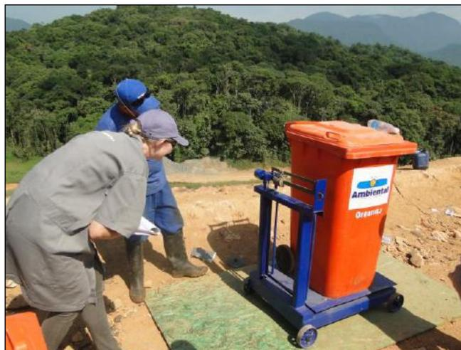
**Figura 37** - Pesagem do resíduo triado
