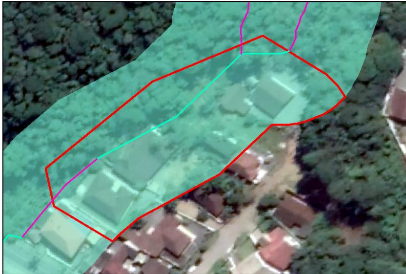
Figura 11 - Edificações sob risco geológico-geotécnico.
