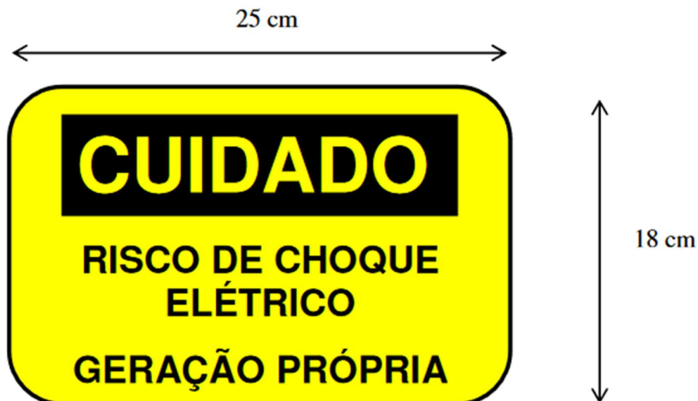
Figura 07: Placa de advertência de geração própria.
