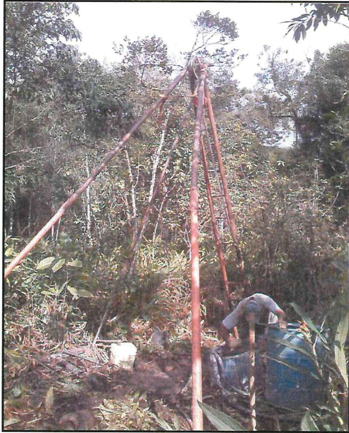
**Figura 01 - Execução do furo de sondagem SPT-01.**
