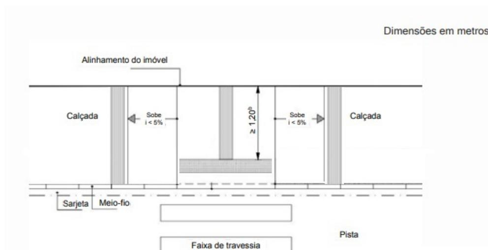
**Figura 4: Tipo 02 - Detalhe Básico para Rampas de acessibilidade para rebaixamento em calçadas com largura menor que 3 metros.**
