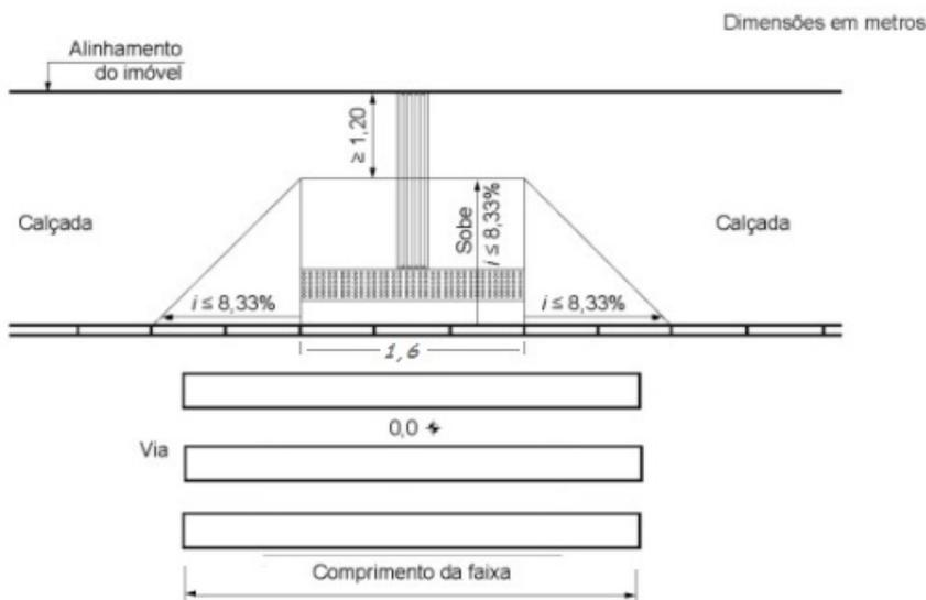
Figura 3: Tipo 01 - Detalhe Básico para Rampas de acessibilidade para rebaixamento em calçadas com largura maior ou igual a 3 metros.
