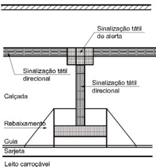
**Figura 6: Detalhe Básico para Travessia em calçada com sinalização tátil direcional, ABNT NBR 16537/2016.**
