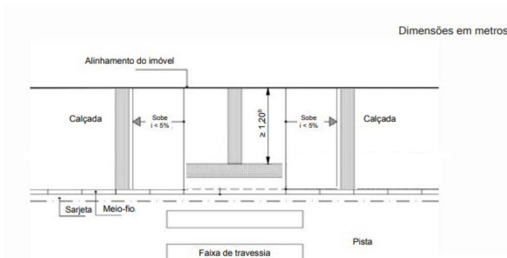
**Figura 2: Tipo 02 - Detalhe Básico para Rampas de acessibilidade para rebaixamento em calçadas com largura menor que 3 metros.**
