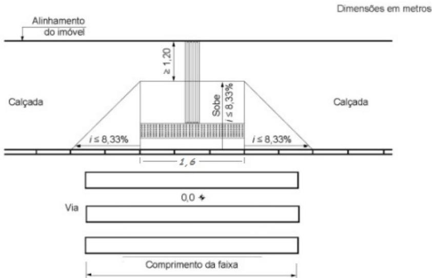
**Figura 1: Tipo 01 - Detalhe Básico para Rampas de acessibilidade para rebaixamento em calçadas com largura maior ou igual a 3 metros.**
