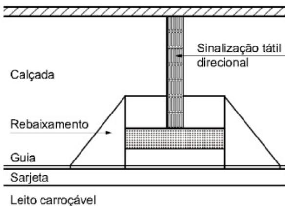
**Figura 5: Detalhe Básico para Travessia a partir de lote edificado, em calçada sem sinalização tátil direcional, ABNT NBR 16537/2016.**
