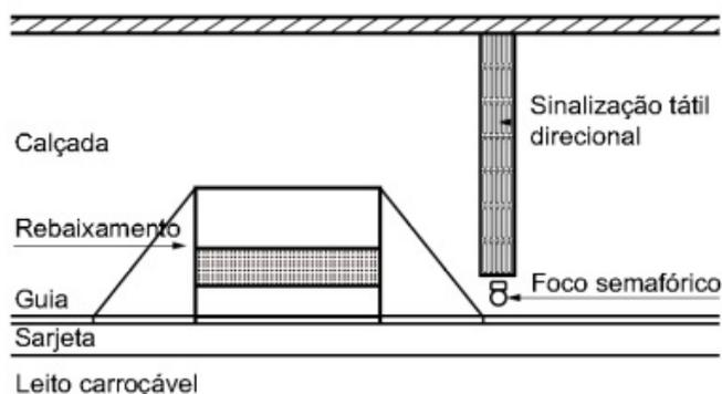
**Figura 7: Detalhe Básico para Travessia com foco semafórico, a partir de lote edificado, em calçada sem sinalização tátil direcional, ABNT NBR 16537/2016.**
