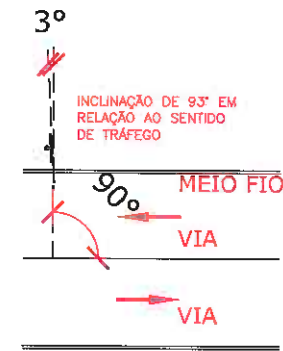
DETALHE DE POSICIONAMENTO EM RELAÇÃO A VIA
