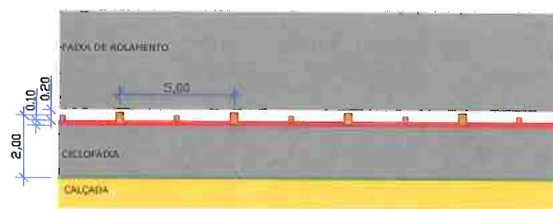
DETALHE I LINHA DE MARCAÇÃO DE CICLOFAIXA
