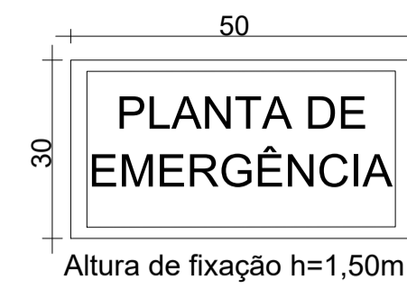
Detalhe placa planta de emergência
