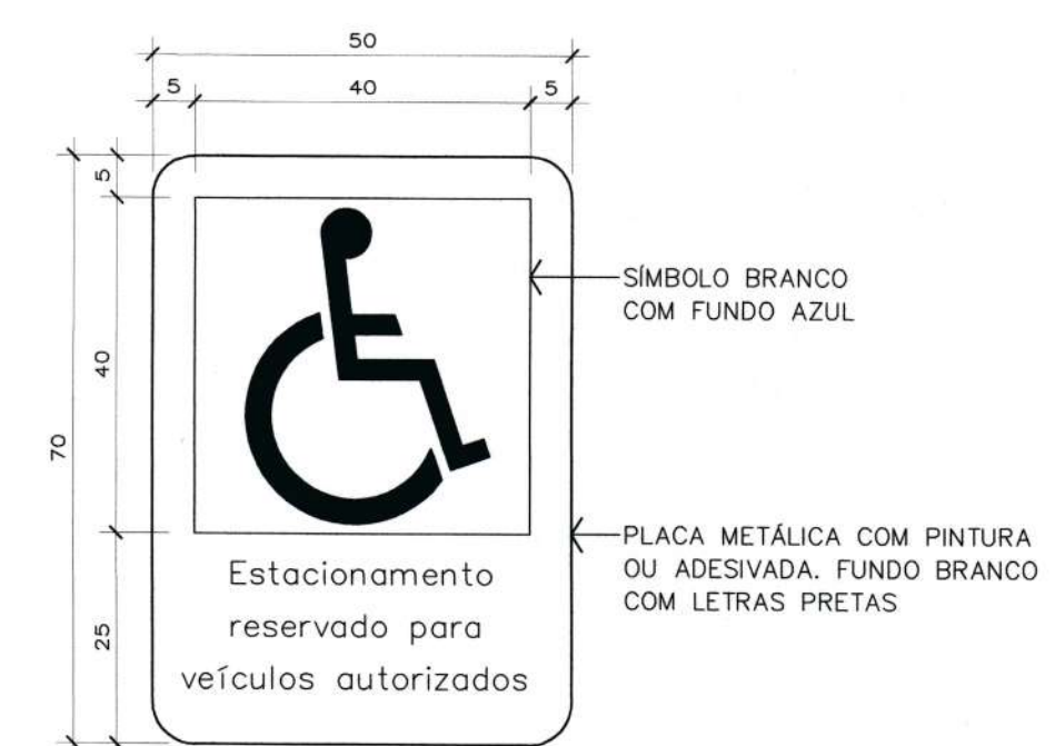
DETALHE SINALIZAÇÃO VERTICAL Escala 1/10
