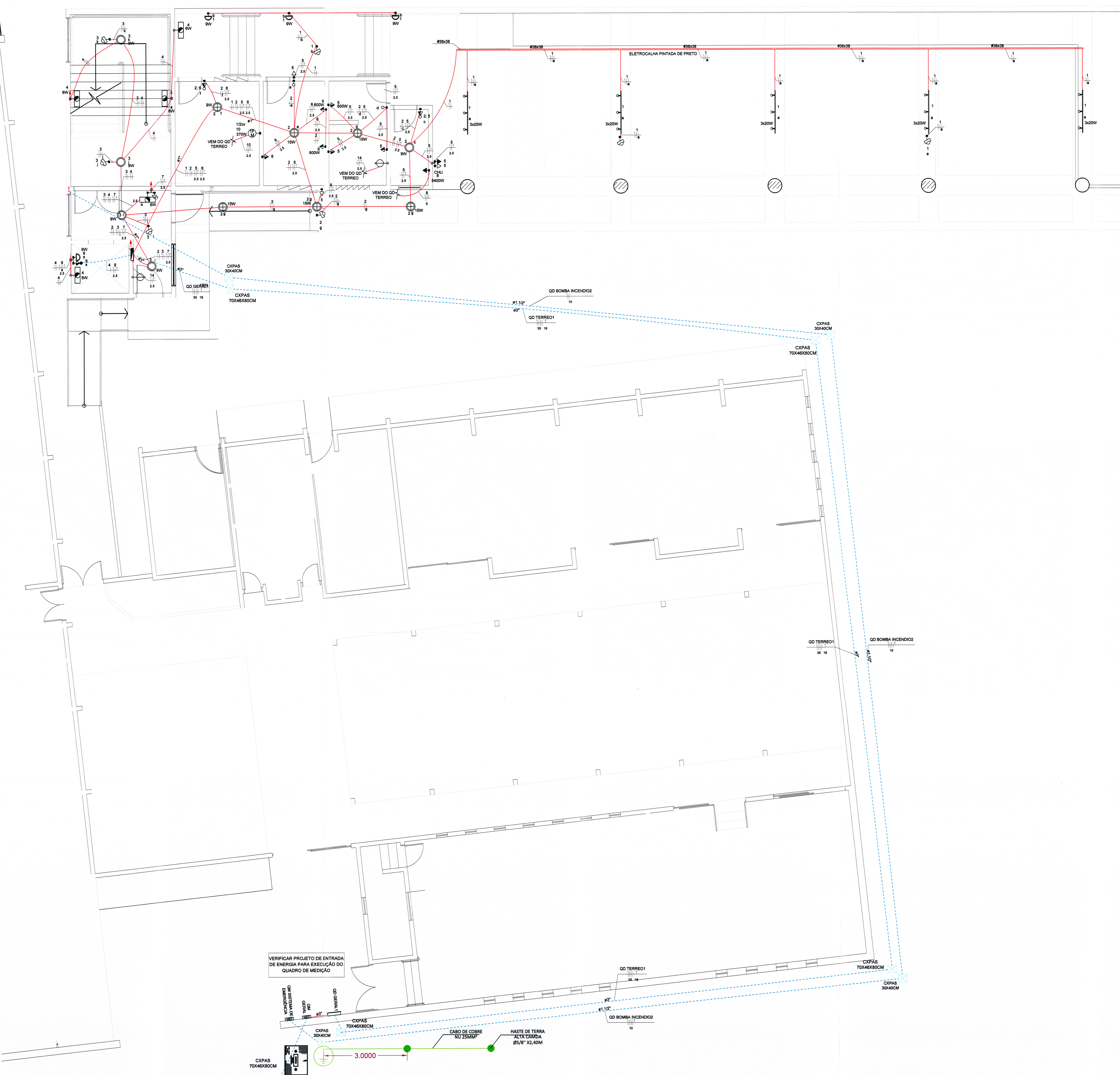
PLANTA BAIXA DISTRIBUIÇÃO ELÉTRICA TERREO ESCALA: 1/50
