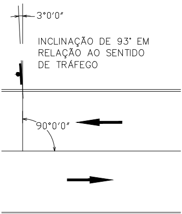
DETALHE DE POSICIONAMENTO EM RELAÇÃO A VIA
