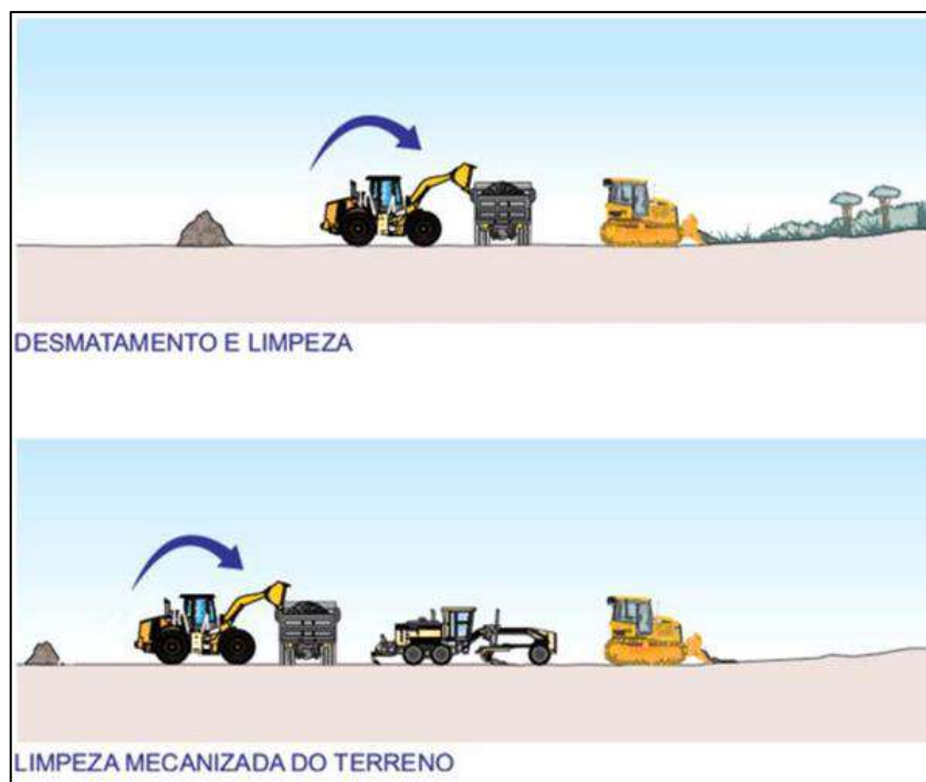
Figura 8 - DETALHE DA LIMPEZA DO TERRENO
