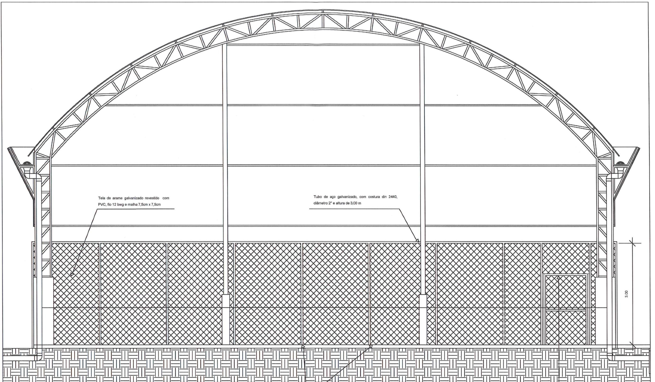
Tela de arame galvanizado revestido com PVC, fio 12 bwg e malha 7,5cm x 7,5cm
