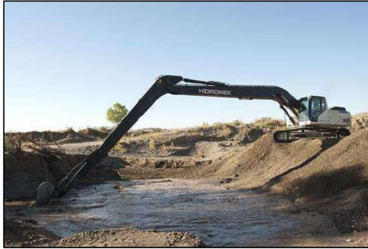
Figura 8.2 - Escavadeira Hidráulica com longo alcance a ser utilizada em conjunto com a Draga.
