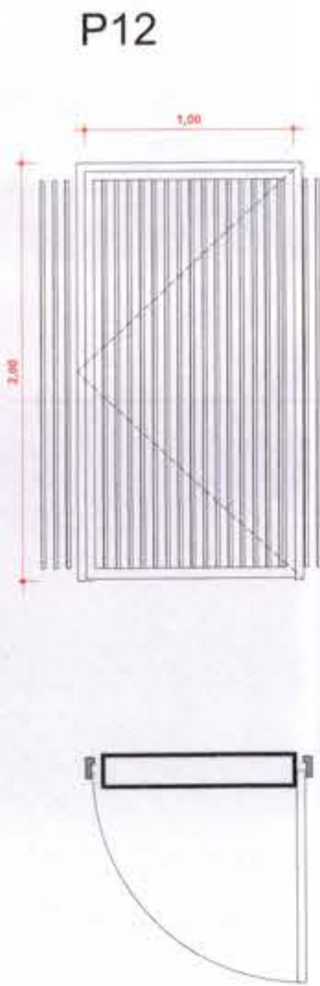
PORTÃO DE FERRO, DE ABRIR, UMA FOLHA, TIPO GRADE COM BARRAS CHATAS, DIMENSÕES 100X200 CM
