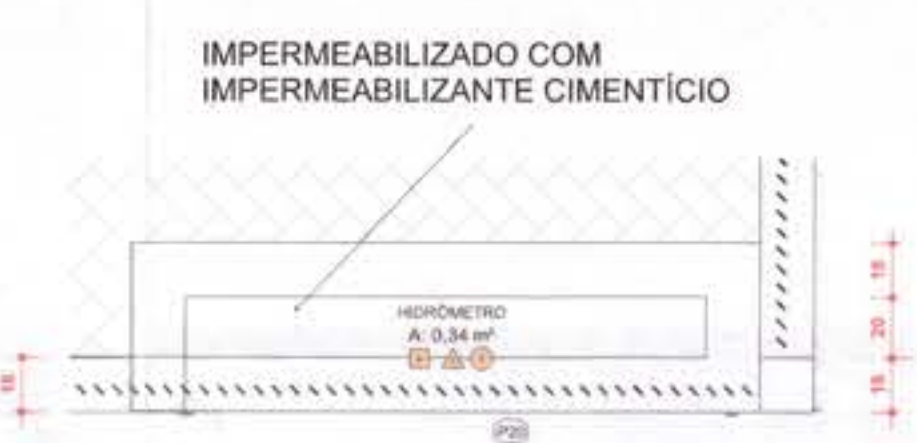
PLANTA - HIDRÔMETRO ESC: 1:25
