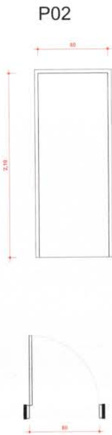
PORTA DE ABRIR UMA FOLHA EM MADEIRA PINTADA NA COR PLATINA DIMENSÕES 80X210CM
