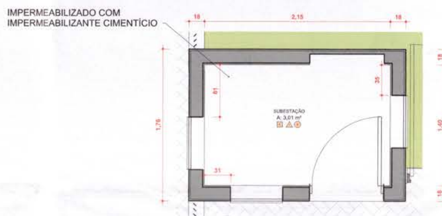
PLANTA - SUBESTAÇÃO ESC: 1:25
