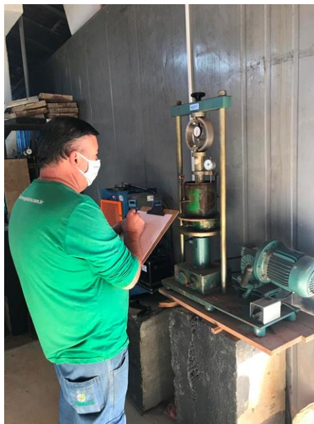
Figura 6.10 - Rompimento de amostra (CBR).
