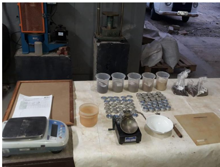
Figura 6.13 - Ensaio de Limites de Liquidez/Plasticidade.
