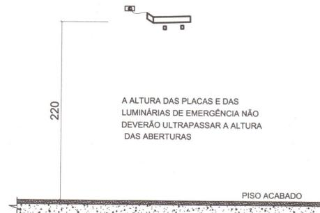
DETALHE DA INSTALAÇÃO DAS LUMINÁRIAS DE EMERGÊNCIA
