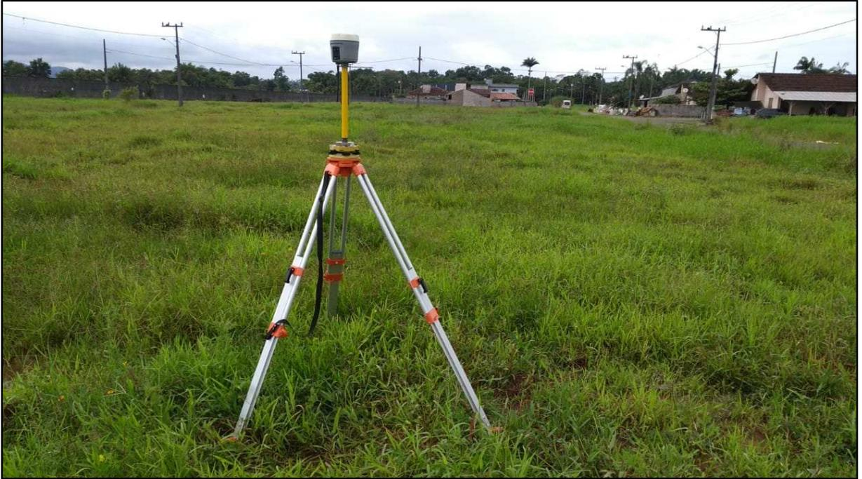
FIGURA 4 – GPS BASE EXECUTANDO O LEVANTAMENTO TOPOGRÁFICO
