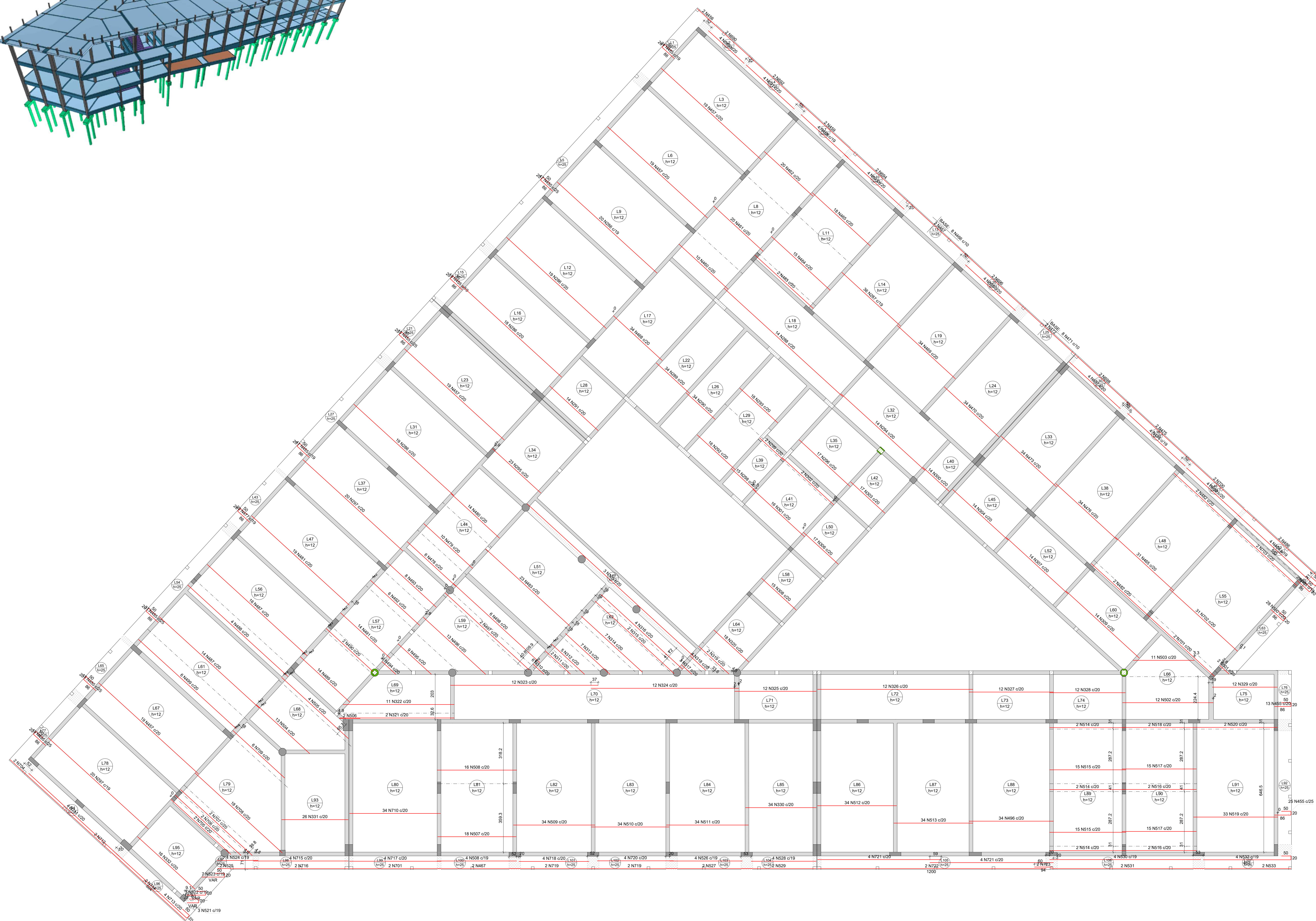
Armação positiva das lajes do pavimento Cobertura (Eixo X)
