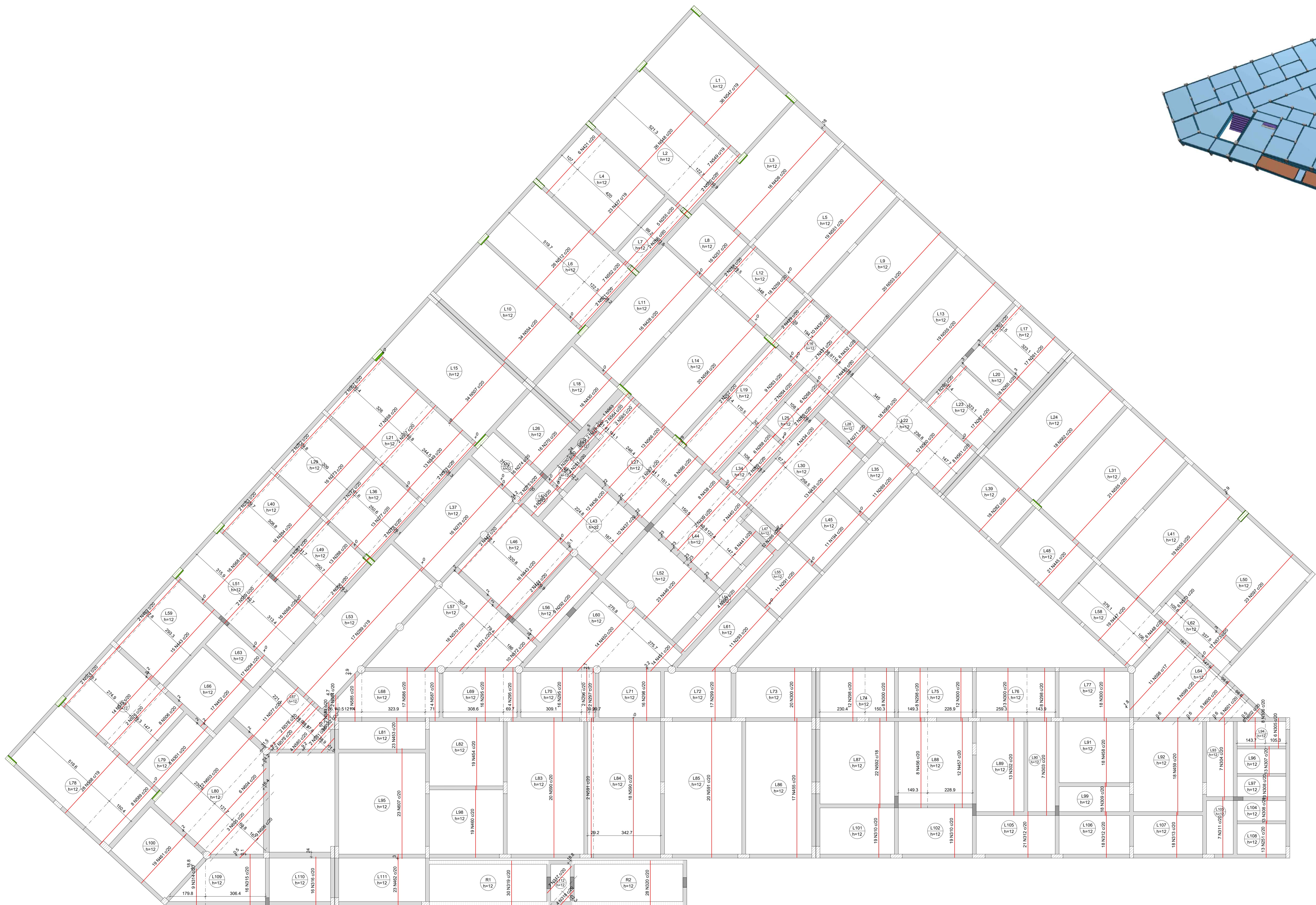
Armação positiva das lajes do pavimento Térreo (Eixo Y)
