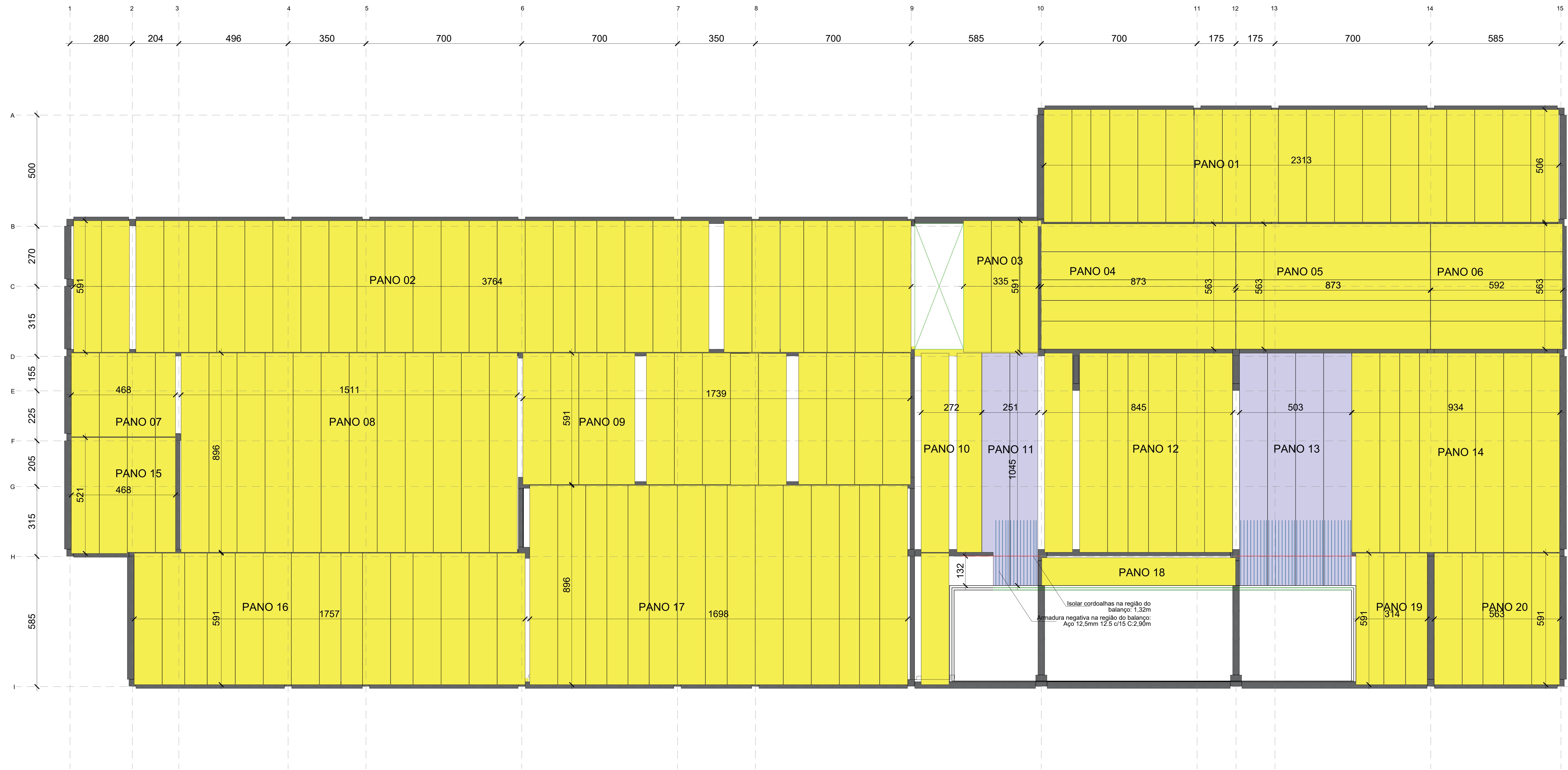
LOCAÇÃO LAJE TERREO escala 1:100
