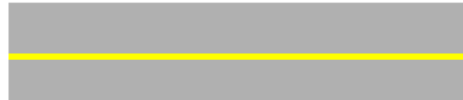
DETALHE F LINHA SIMPLES SECCIONADA AMARELA (2X4X2) - LARGURA = 10 CM
