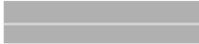
DETALHE B LINHA SIMPLES SECCIONADA BRANCA (2X4X2) - LARGURA = 10 CM
