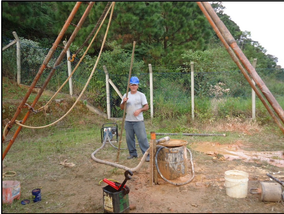
Figura 07 - Execução do furo de sondagem SPT-03
