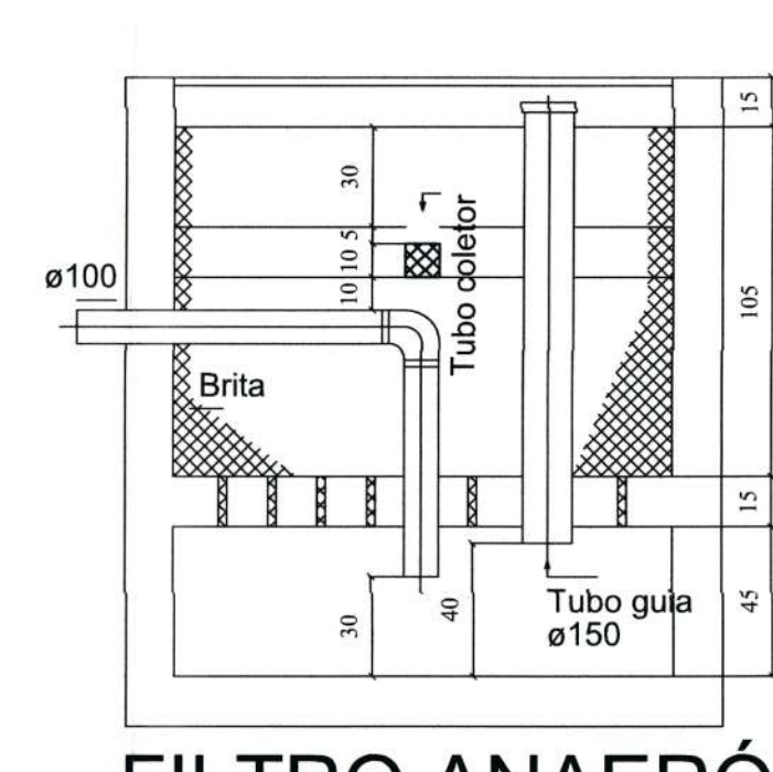
FILTRO ANAERÓBIO CORTE - ESC. 1:25
