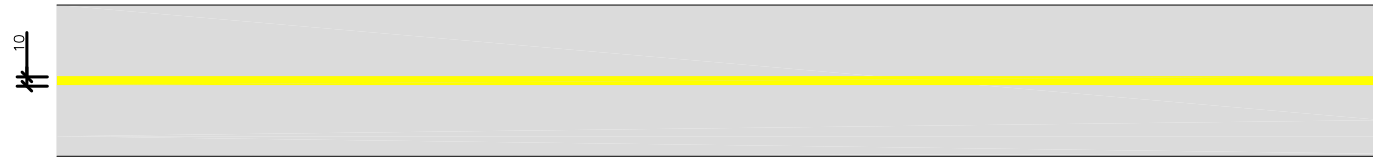
DETALHE A FAIXA SIMPLES CONTÍNUA AMARELA
