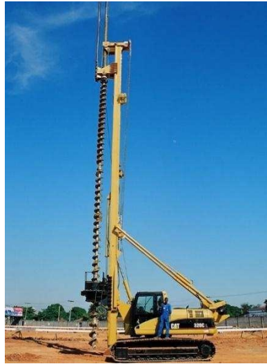
Perfuratriz com torre metálica para execução de estaca hélice contínua
