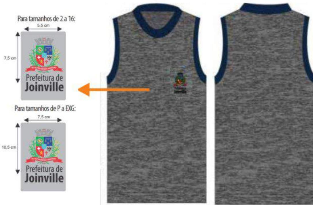
**Regata confeccionada em meia malha 67% poliéster (com 12% de poliéster preto), 33% viscose com gramatura de 160 g/m<sup>2</sup> na cor cinza mescla com a tolerância de variação de gramatura de 5% para (+/-).**
