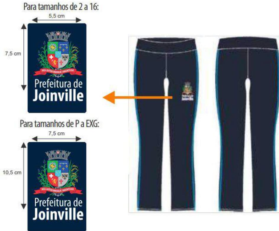
Calça confeccionada em Suplex 92% poliamida, 8% Elastano, com gramatura 300g/m<sup>2</sup>, na cor azul marinho, Pantone 19-3921TPX, com tolerância de variação de gramatura de 5% para (+/-). Nas laterais da peça deverá ser aplicada uma faixa, com largura de 1cm, em meia malha 67% poliéster, 33% viscose, com gramatura de 160g/m<sup>2</sup> na cor azul claro, Pantone 16-4021TPX, com tolerância de variação de gramatura de 5% (+/-).
