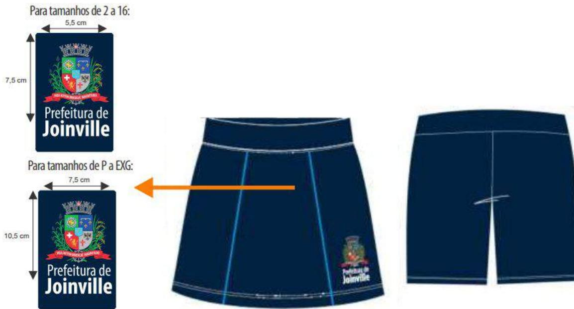
*Shorts-saia confeccionada em Helanca 100% poliamida, com gramatura 260g/m<sup>2</sup>, na cor azul marinho, Pantone 19-3921TPX, com tolerância de variação de gramatura de 5% para (+/-). A saia deverá conter, sobrepostas, duas faixas conforme layout, com largura de 1cm em meia malha 67% poliéster, 33% viscose gramatura 160g/m<sup>2</sup>, na cor azul claro, Pantone 16-4021TPX, com tolerância de variação de gramatura de 5% (+/-).*
