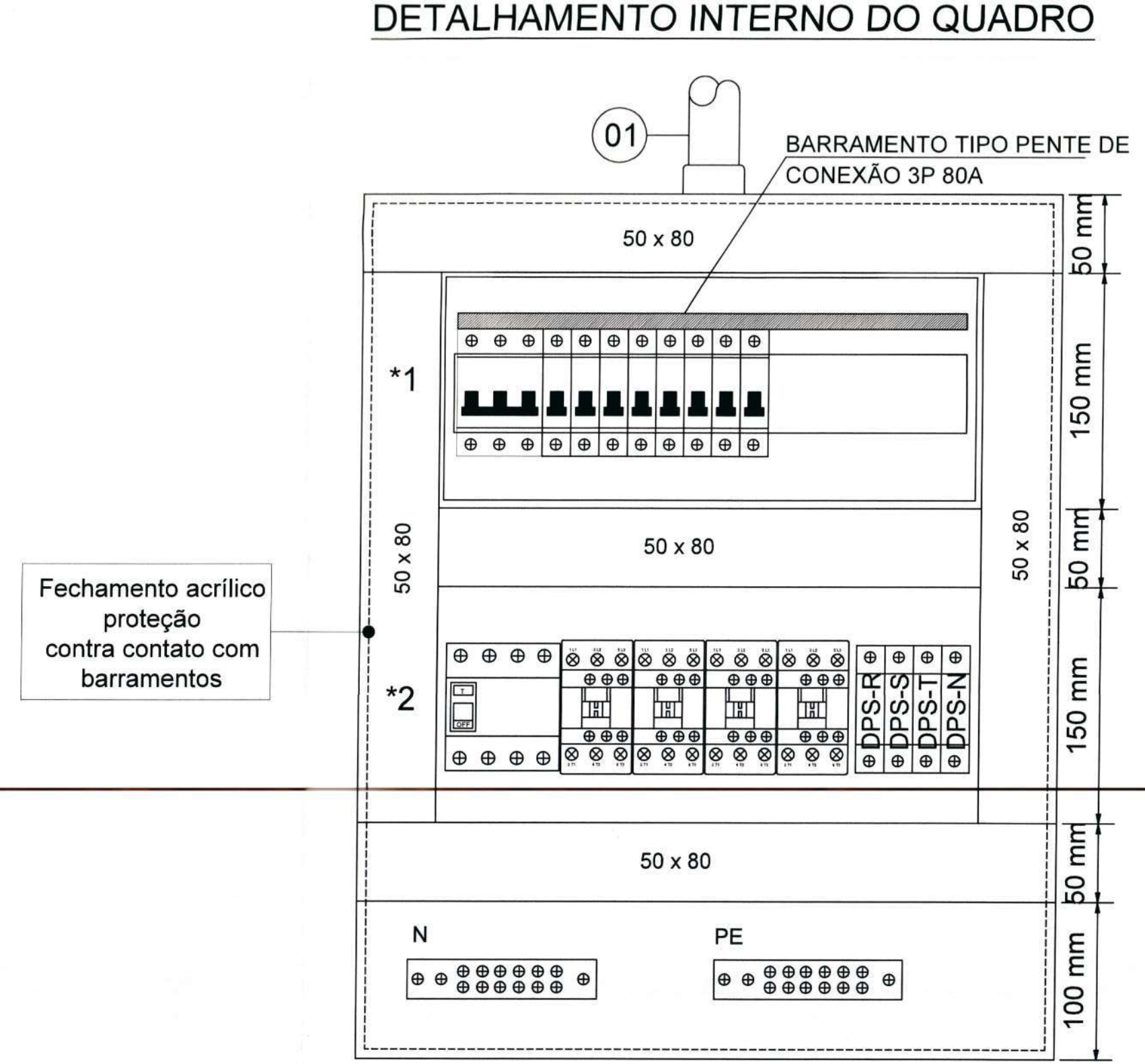
QD 01 - Geral Proteção 25A Quadro 600x400x200mm
