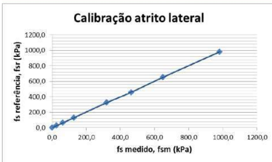
Figura 2 – Calibração do sensor de atrito lateral.
