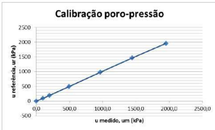
Figura 3 – Calibração do sensor de poro-pressão.
