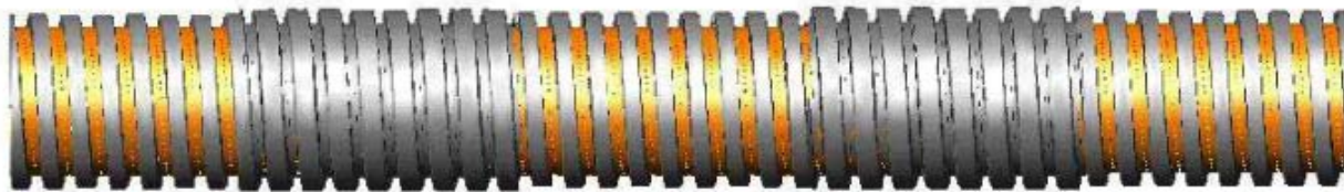
Figura 3.23 – Ilustração do reparo do tubo com luvas de emenda
