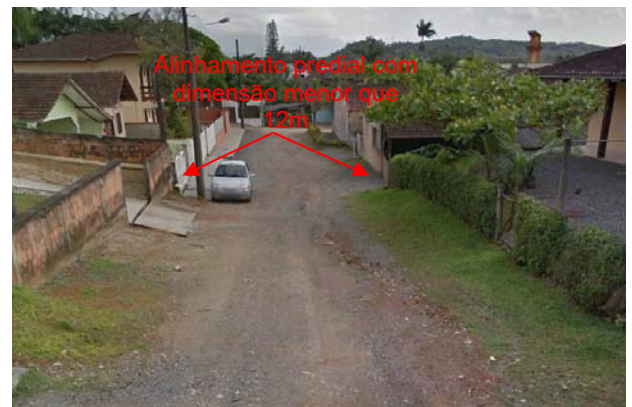
Figura 1.2 - Rua Orestes Girardi - Trecho com alinhamento predial existente, impactando na largura da via projetada. Fonte: Azimute, 2020.
