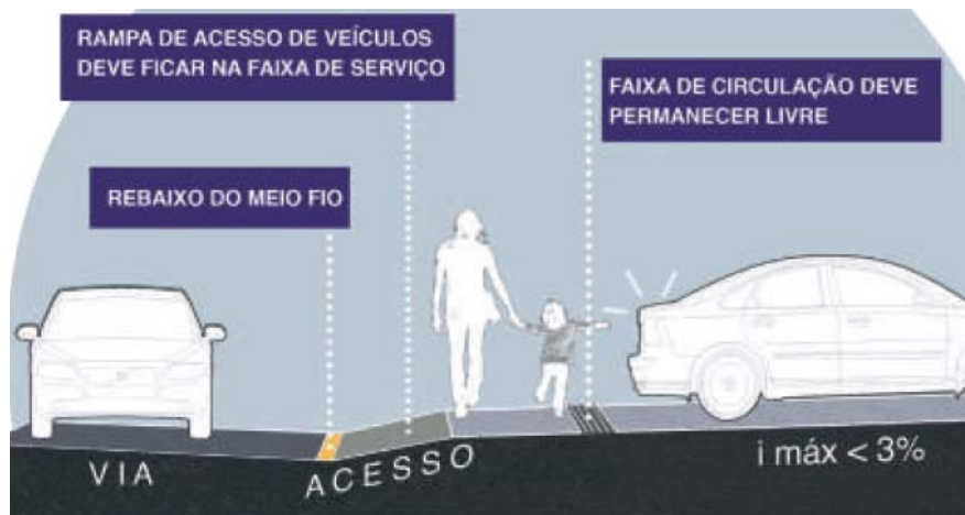
Figura 4.8 - Rebaixo de veículos.
