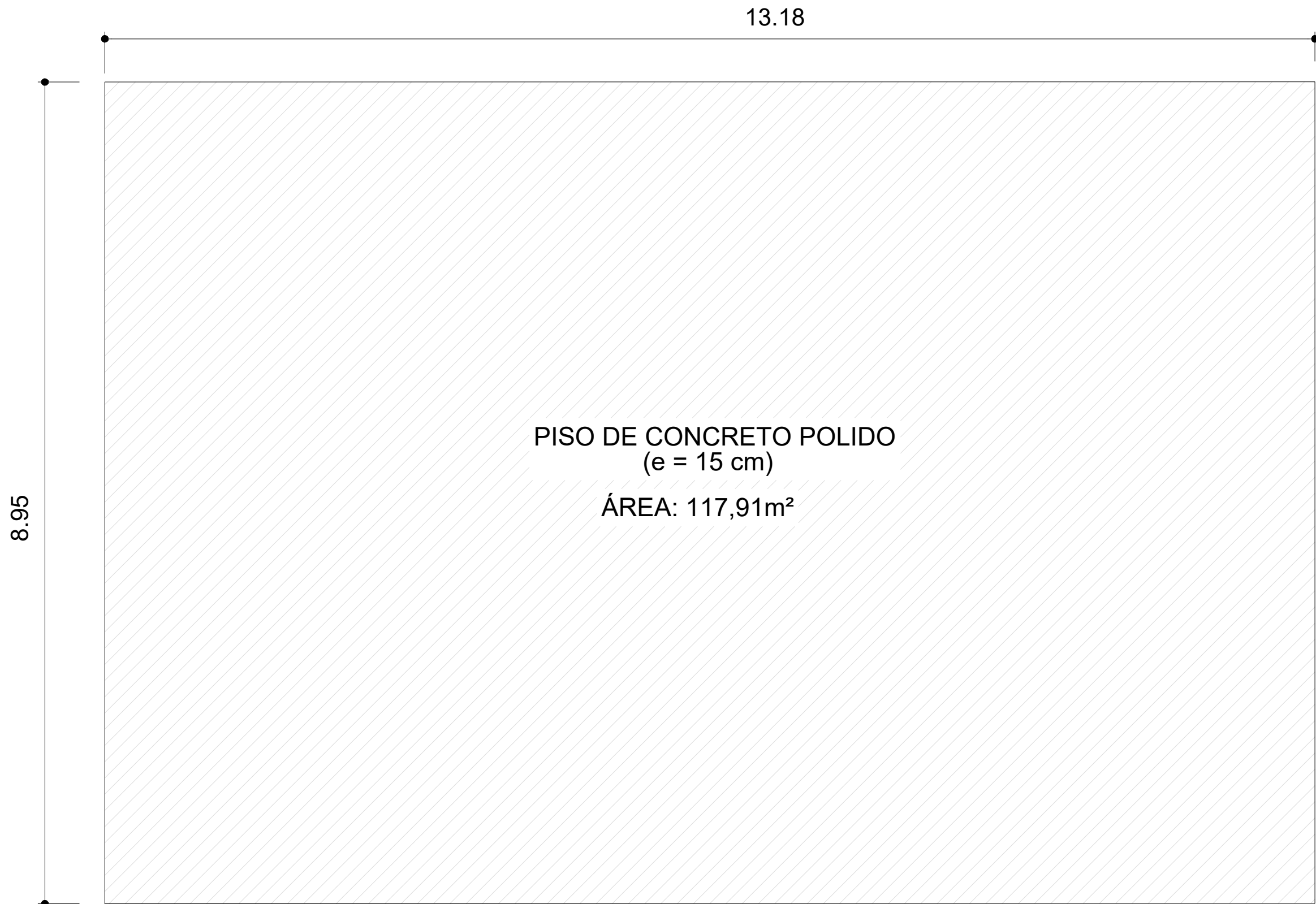
PLANTA PISO DE CONCRETO Escala 1:50
