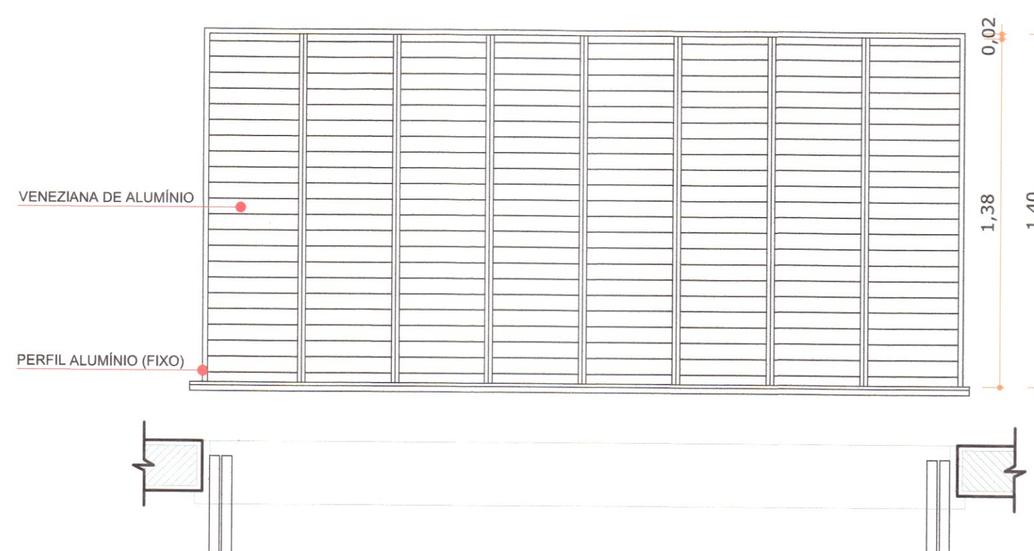
JA.05 140 X 300 CAMARÃO ALUMÍNIO NATURAL ESCALA | 1:20
