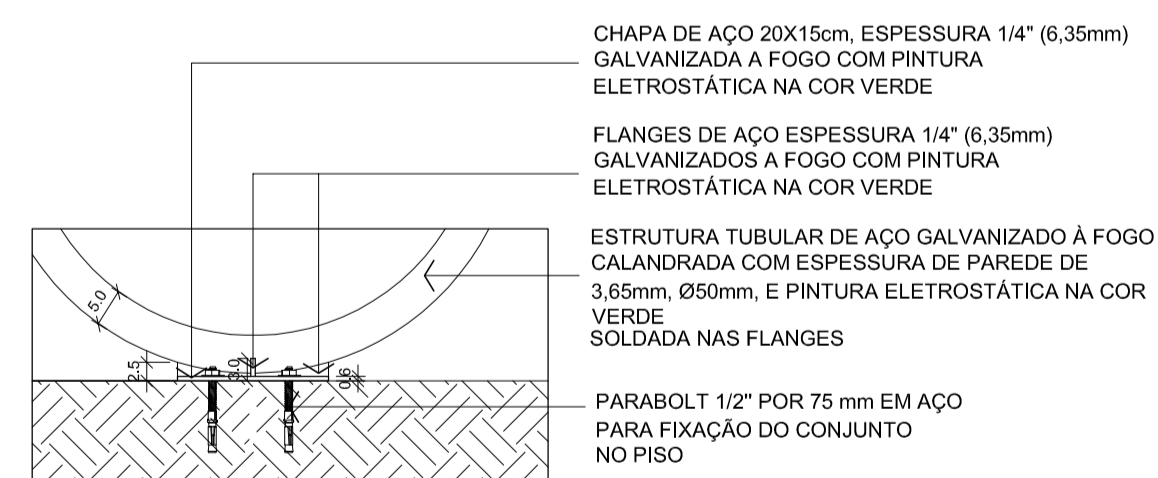
CORTE FIXAÇÃO DOS PARACICLOS Escala 1/10
