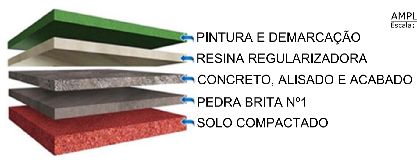
FIGURA 1 - ESQUEMÁTICA DO ACABAMENTO DO PISO DA QUADRA Sem escala
