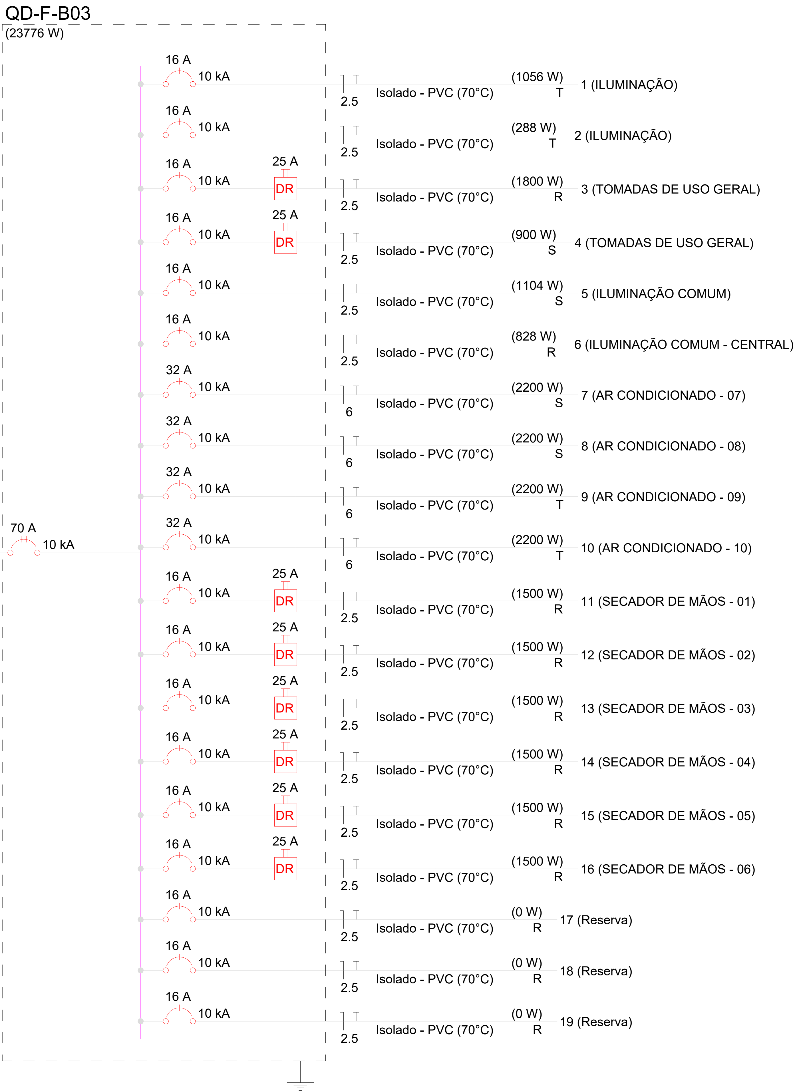
Quadro de Cargas (QD-F-B03) - PAV SUPERIOR
