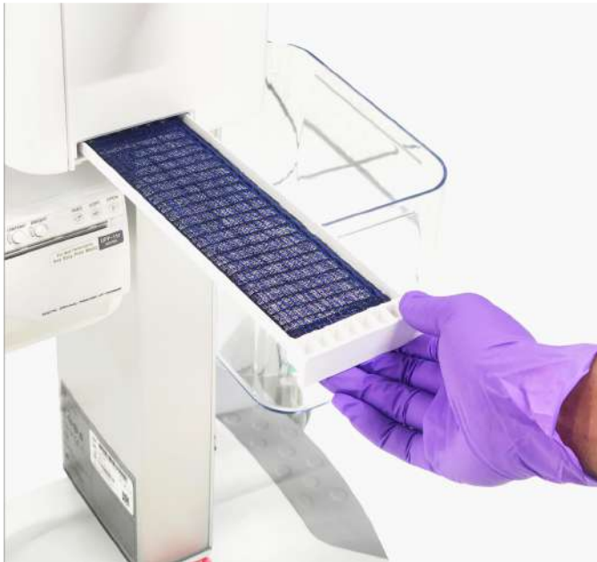
Remoção do filtro de ar do sistema
