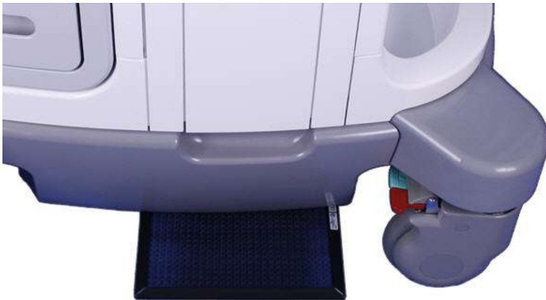
Remoção do filtro de ar do sistema
