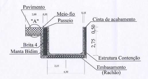
Detalhe "A" - Sequencia de execução e camadas do pavimento
