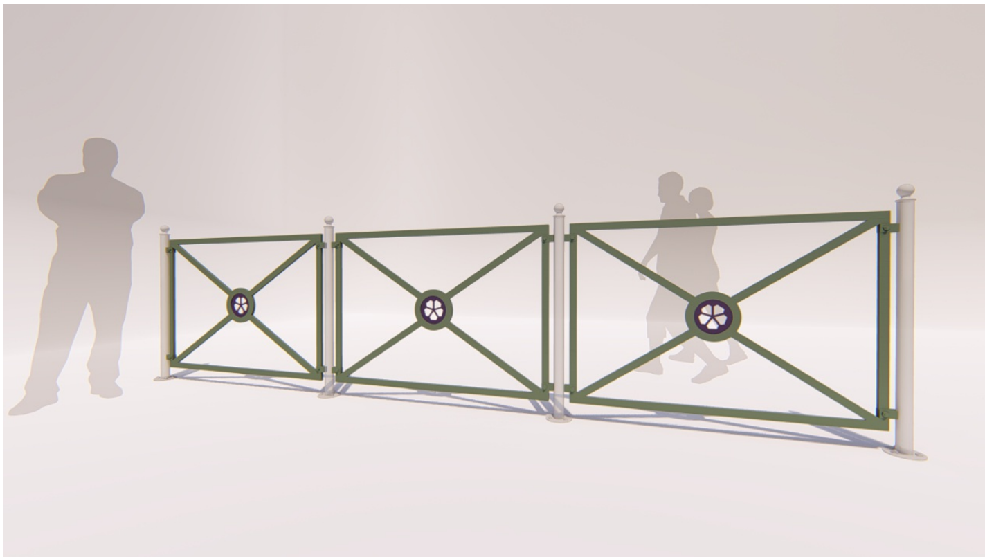
4.9.4 - Defesa modelo 03 (bailarina) – gradil sem os pilares que são os mesmos que dos balizadores (tubo retangular de 40x20mm, espessura da parede de 3mm, em aço galvanizado a fogo e pintura eletrostática a pó, com abas de fixação e parafuso, espessura da parede de 3mm em aço galvanização a fogo e pintura eletrostática a pó, chapa recortada com espessura da parede de 3mm (flor) em aço galvanizado a fogo e pintura eletrostática a pó, preenchimento em tubo com diâmetro de 10mm, espessura da parede de 1,5mm em aço galvanizado a fogo e pintura eletrostática a pó e espaço para colocação de placa de publicidade, dimensões do gradil: 1,48m de largura e 1,02m de altura) - instalado
