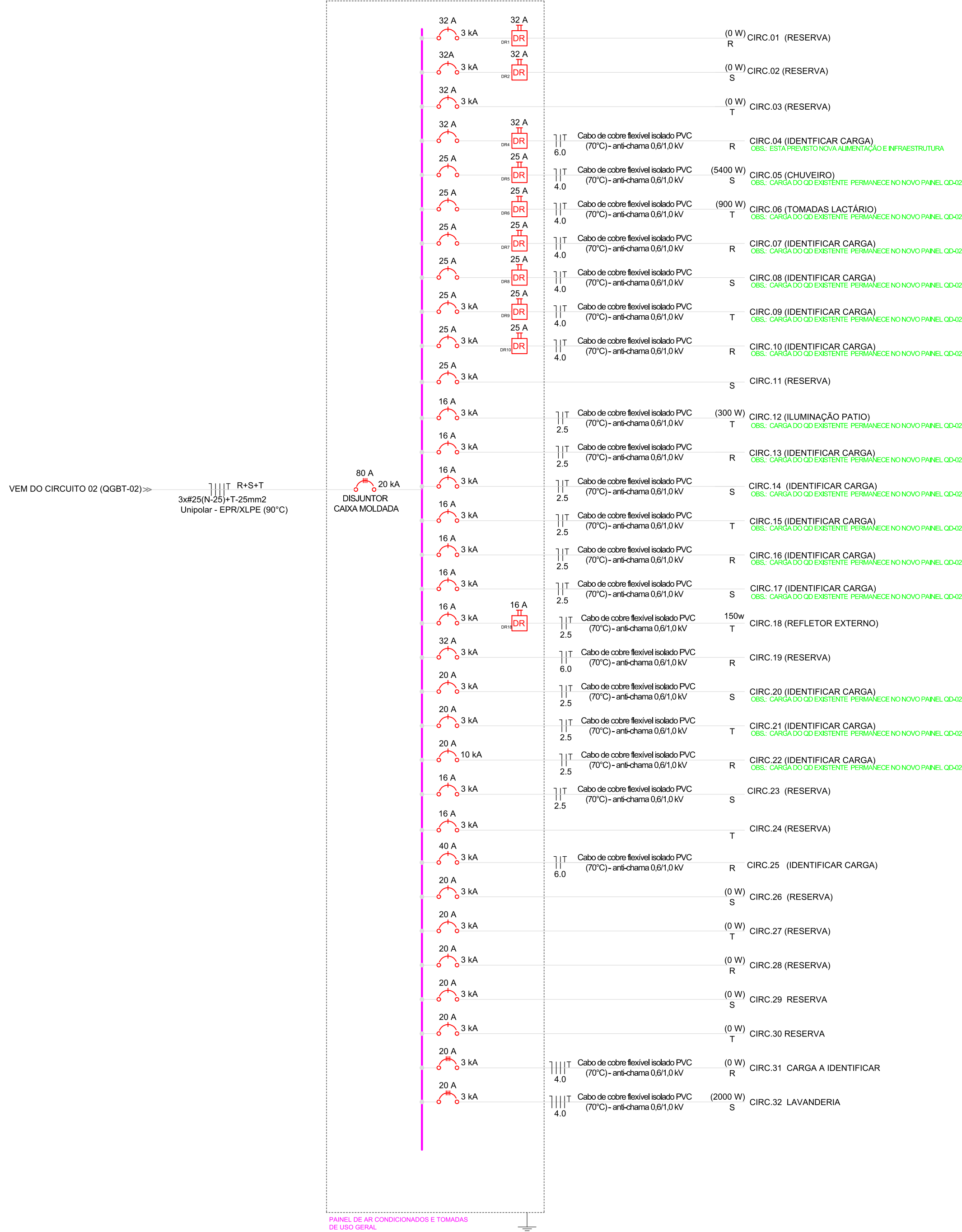
QD-02 (QUADRO DE DISTRIBUIÇÃO DE FORÇA)
