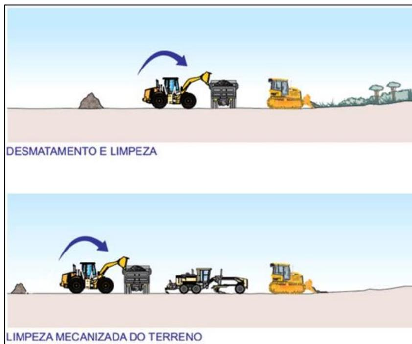
Figura 8 - DETALHE DA LIMPEZA DO TERRENO
